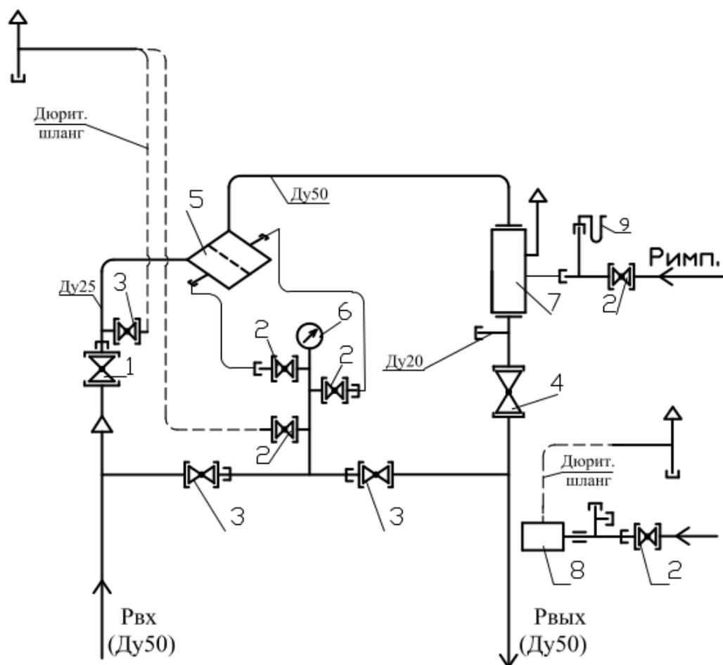
1-кран шаровой КШ-25; 2-кран шаровой КШ-15; 3-кран шаровой КШ-20; 4-кран шаровой КШ-50; 5-фильтр типа ФГТ; 6-манометр МТ-16; 7-регулятор давления газа ; 8-клапан предохранительный сбросной КПС-Н; 9-выходной манометр(не комплектуется).
