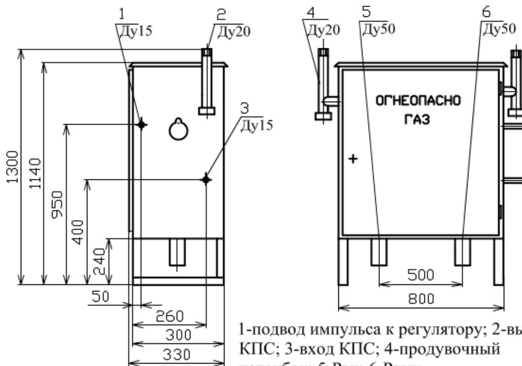
1-подвод импульса к регулятору; 2-выход КПС; 3-вход КПС; 4-продувочный патрубок; 5-Рвх; 6-Рвых.
