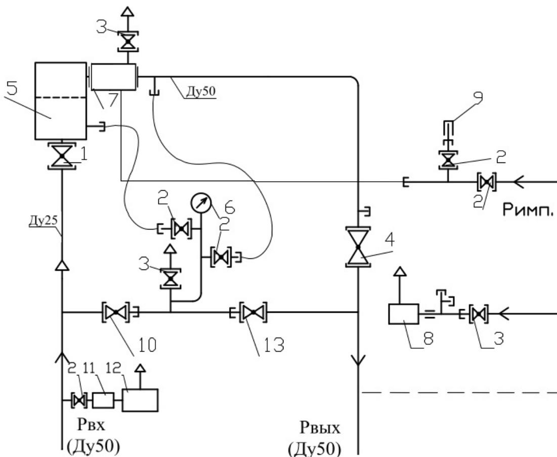
1-кран шаровой КШ-25; 2-кран шаровой КШ-15; 3-кран шаровой КШ-20; 4-кран шаровой КШ-50; 5-фильтр типа ФГ-25/50С12; 6-входной манометр МТ-16; 7-регулятор давления газа РДНК-50; 8-клапан предохранительный сбросной КПС-20Н; 9-выходной манометр (водяным не комплектуется); 10-кран шаровой КШ-20; 11-регулятор давления газа РДСГ 1-1.2; 12-газогорелочное устройство ГИИВ 3,65; 13-регулирующий кран Ду20 .
